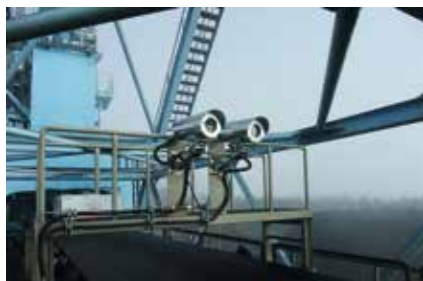
Le termocamere FLIR, alloggiare in custodie protettive, sono montate sopra ai nastri trasportatori per il carbone.
