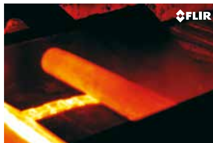
Immagine termica e visibile; il vapore oscura la vista del tronco, mentre le vasche per i tronchi sono chiaramente visibili nella immagine termica.
