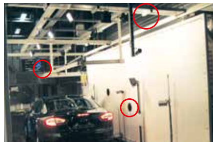
Ford Genk possiede tre termocamere per testare il sistema di riscaldamento del vetro anteriore, di quello posteriore e del condizionatore. Le posizioni delle termocamere sono segnate in rosso
