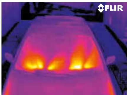
Ispezione dello sbrinamento del parabrezza di una vettura.
