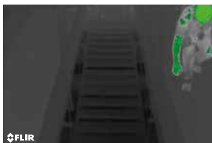
Se una persona entra nell'area del nastro trasportatore, l'allarme automatico di temperatura arresta immediatamente il nastro.
