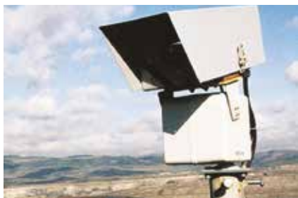
La termocamera FLIR Systems montata su un pennone nella miniera di Nástup Mines Cooperation.
