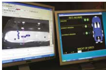
Il PLC confronta i dati di misurazione con i parametri determinati in precedenza.
