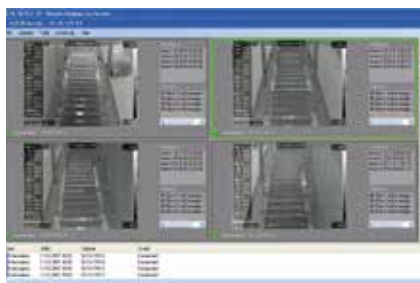
Questa immagine prodotta dal software FLIR mostra le riprese delle quattro termocamere FLIR che sorvegliano tutti e otto i nastri trasportatori.
