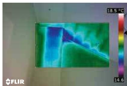
Queste immagini Picture-in-Picture mostrano delle infiltrazioni d'acqua non visibili ad occhio nudo, ma chiaramente evidenziate nell'immagine termografica.
