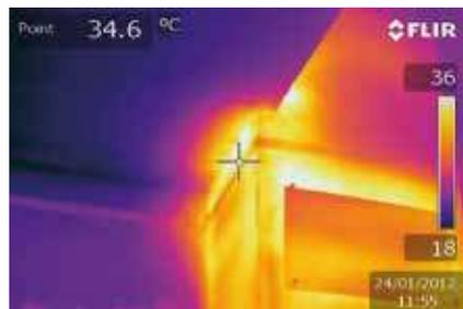
Le tubazioni dell'acqua calda inglobate nella parete stanno perdendo. In questo caso sono presenti dei segni evidenti della perdita. La termocamera aiuta a trovare con esattezza dove è localizzata la perdita.
