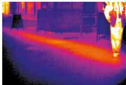
*Le termocamere rendono perfettamente visibili le condutture interrate di una rete di teleriscaldamento. Una perdita nella rete può essere facilmente localizzata*
