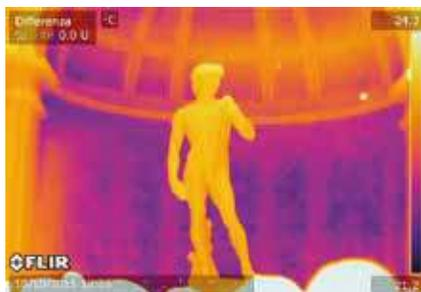
Questa immagine termografica rivela la struttura nascosta di muri e pilastri dell'abside.
