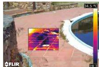
Queste immagini mostrano come è possibile combinare l'immagine visiva e quella ad infrarossi in una immagine Thermal Fusion ( a sinistra) o in un'immagine Picture-in-Picture (a destra).
