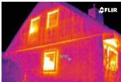
*Questa immagine termografica mostra un esempio di isolamento carente in un edificio residenziale, utilizzato in un corso di termografia erogato da Rockwool.*
