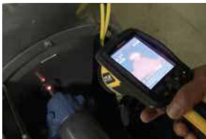
*Ispezione termografica di un componente meccanico.*
