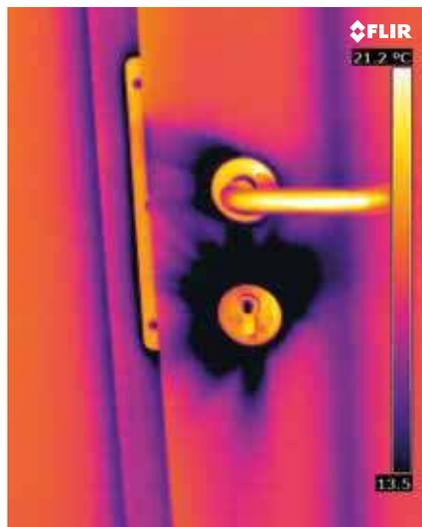
*Fuga d'aria durante l'ispezione "blower door" per la valutazione dell'ermeticità.*
