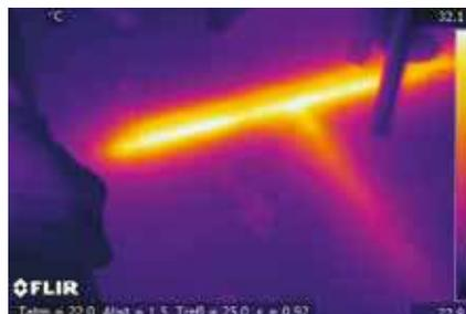
Questa immagine termografica mostra dove è stato installato il tubo dell'acqua calda sotto il pavimento.
