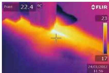
L'immagine termografica mostra chiaramente la perdita di un tubo nel pavimento.
