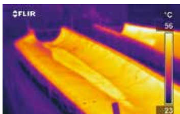
Immagine termica di uno stampaggio materie termoplastiche
