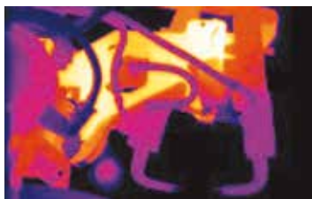
Punto caldo su robot di saldatura
