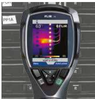
FLIR i3, temperatura in 3600 punti
