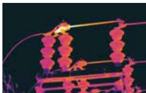
L'ispezione di una sottostazione rivela la presenza di componenti surriscaldati.
