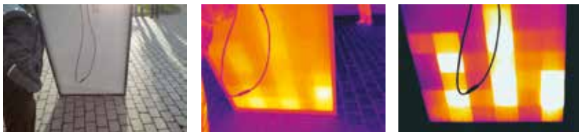
Le immagini, riprese dalla parte posteriore dello stesso pannello solare, mostrano molto meno i riflessi rispetto alla parte anteriore, rendendo molto più accurate le misurazioni di temperatura.
