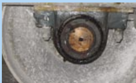
L'albero e i cuscinetti surriscaldati possono essere indice di guasto dei cuscinetti, scarsa lubrificazione o disallineamento.
