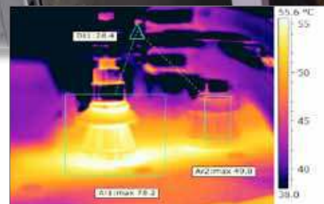
Avendo temperature prossime a 80°C, questo trasformatore necessita di un'ulteriore ispezione.
