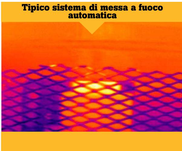
Figura 3. I tipici sistemi di messa a fuoco automatica si concentrano sulla protezione in metallo
