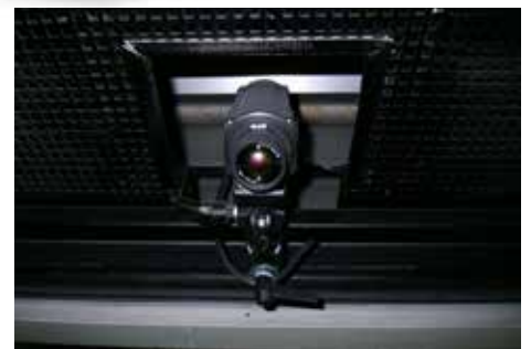
Una soluzione centrale: TOPA ha installato termocamere FLIR A310 con obiettivi grandangolari da 45° su ciascuno dei 10 dinamometri.
