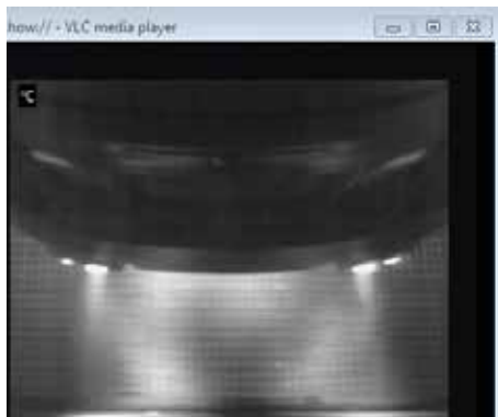
Immagini termiche della parte posteriore. Visibile a sinistra: i flap di scarico aperti ad un regime più elevato.
