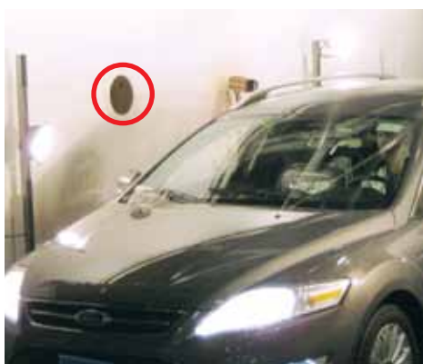
La termocamera dietro il foro registra la temperatura dell'aria che fuoriesce dalla bocchetta del condizionatore.
