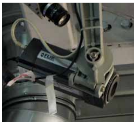
Questa termocamera FLIR A320 è utilizzata per controllare se il sistema di riscaldamento del vetro anteriore ha delle resistenze difettose.
