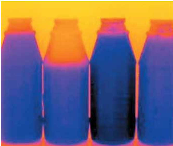
Questa immagine ad infrarossi mostra le bottiglie mentre vengono riempite automaticamente, così da poter rimuovere quelle troppo o troppo poco piene. Se una bottiglia o un contenitore sono in vetro o in plastica di colore scuro, le termocamere per questo scopo risultano essere più efficaci delle normali videocamere.
