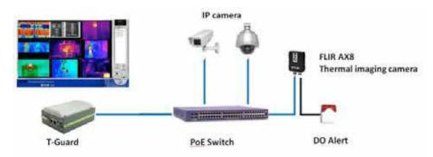
FGuard utilizza la termocamera FLIR AX-8 e il videoregistratore di rete ADE AD-TG200. Gestisce gli allarmi pilotati da temperatura attivati dal sensore FLIR AX8, e le informazioni provenienti da altri sensori come telecamere IP, misuratori di tensione e misuratori di temperatura ambiente.
