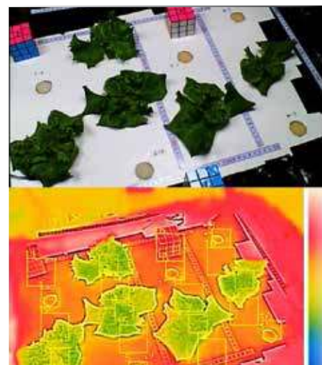
La FLIR AX8 produce immagini termiche da 80 x 60 pixel unitamente a informazioni sulla temperatura.
