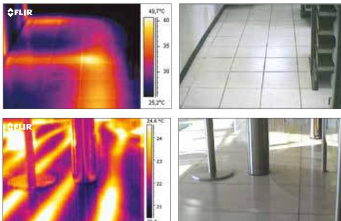
*Problemi nel sistema di riscaldamento a pavimento sono chiaramente visibili con una termocamera ad infrarossi.*
