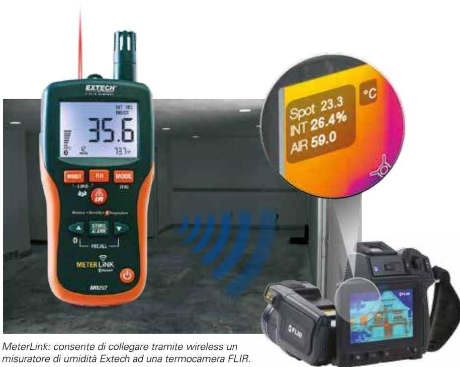
*MeterLink: consente di collegare tramite wireless un misuratore di umidità Extech ad una termocamera FLIR.*
