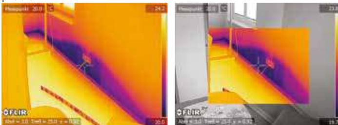
*Questo caso di danni da infiltrazione d'acqua mostra chiaramente i vantaggi della funzione FLIR Picture-in-Picture poiché il cliente può capire facilmente a cosa si riferisce l'immagine termica, mentre sarebbe più difficile con la sola immagine termica a disposizione.*
