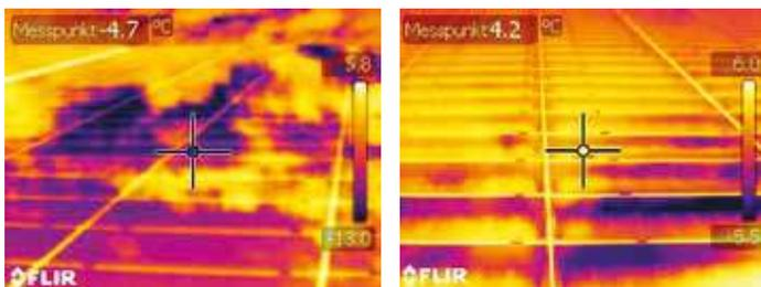
*Questa immagine termica mostra che il riflesso può determinare un problema. La termocamera visualizza l'immagine termica comprensiva dei riflessi causati dalla nuvola. Nel misurare il riflesso, la temperatura indicata sarà influenzata dalla temperatura del pannello e la temperatura riflessa apparente della nuvola.*
