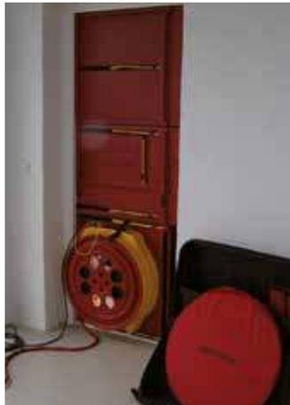
*L'apparecchiatura del Blower Door in genere viene installata nella porta di ingresso.*
