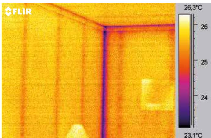
*Immagine termica ripresa dall'interno. Il telaio è visibile, così come lo sono le viti che fissano la copertura esterna al telaio. L'angolo è chiaramente più freddo, un fenomeno detto "effetto angolo", ma non c'è nulla di sbagliato.*
