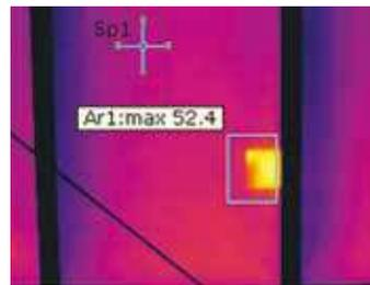
*Questa immagine termica mostra un punto caldo dovuto alla rottura di una cella in un modulo standard da 60 celle.*
