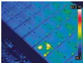
*Questa immagine termica mostra un esempio della cosiddetta 'configurazione patchwork', che indica che questo pannello ha un diodo di bypass difettoso.*
