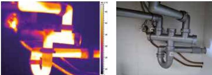
*Rileva facilmente problemi o guasti agli impianti idraulici mediante l'uso di una termocamera ad infrarossi*
