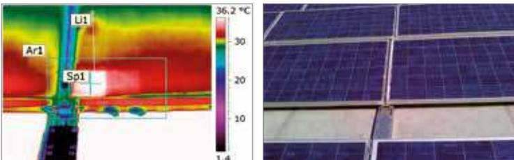
*Le celle solari difettose generano un eccesso di calore, rendendole facili da individuare con i metodi termografici.*
