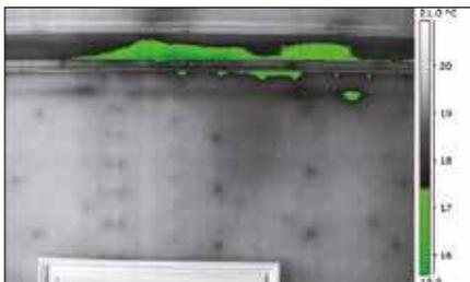
*L'allarme isolamento mostra le aree con temperatura inferiore o superiore un dato intervallo, contrassegnandole con un colore differente.*
