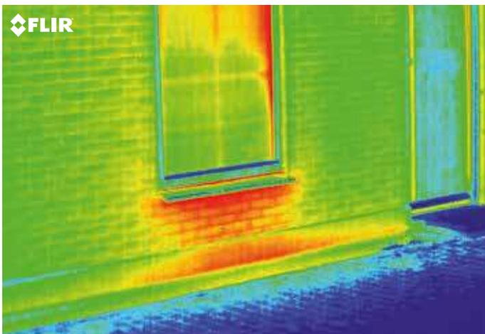
*L'immagine termica evidenzia chiaramente un isolamento insufficiente nella parete sotto il soffitto.*
