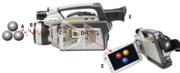
La termografia è l'arte di trasformare un'immagine ad infrarossi in un'immagine radiometrica, su cui è possibile leggere i valori della temperatura. Quindi ogni pixel nell'immagine radiometrica è in effetti una misurazione di temperatura. Affinché ciò sia possibile, nella termocamera ad infrarossi vengono introdotti degli algoritmi complessi.
