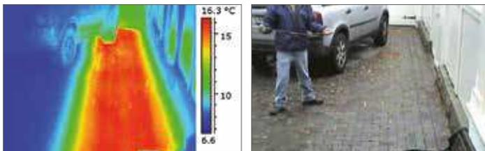
*I guasti in un sistema di teleriscaldamento sono chiaramente visibili con una termocamera.*
