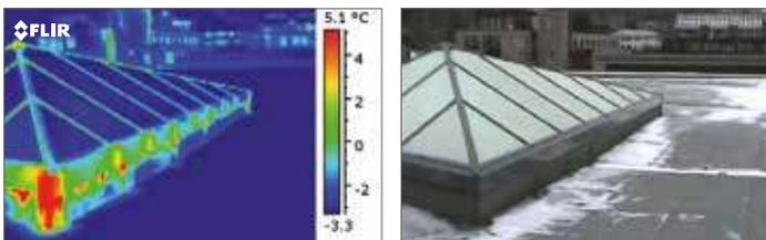
*Lucernario sopra un cortile interno. Non penetra acqua, ma ci sono infiltrazioni d'aria. L'aria calda fuoriesce a causa della sovrappressione. E' necessario sigillare il lucernario.*
