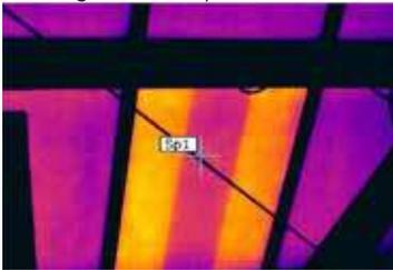
*Due serie di celle appaiono calde nell'immagine termografica, indicando la rottura dei diodi di bypass.*
