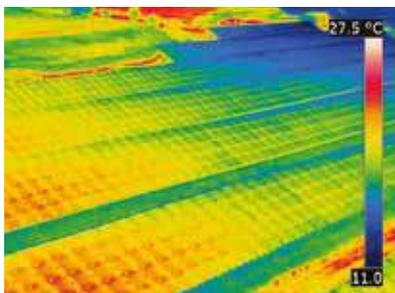
Per non trarre conclusioni errate è necessario tenere la termocamera ad un angolo corretto nel corso dell'ispezione dei pannelli solari.
