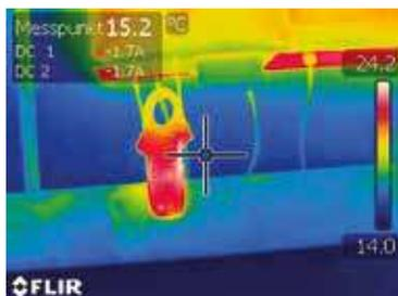
Questo inverter converte la corrente continua prodotta dai pannelli solari in corrente alternata. Le termocamere possono anche essere utilizzate per ispezionare questo tipo di apparecchiature. Una pinza amperometrica esterna Extech può fornire ulteriori informazioni.
