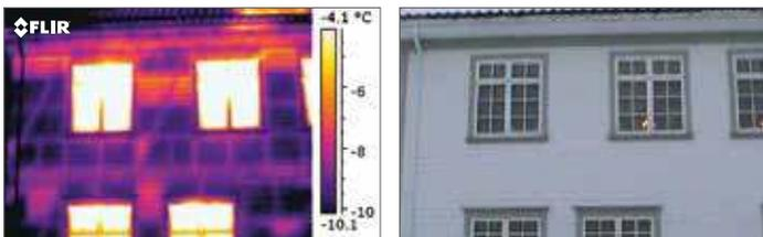
*Costruzione a telaio. Mancano molte sezioni di isolamento, come evidenziato dai colori più caldi.*
