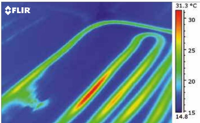
*L'immagine ad infrarossi mostra la perdita d'acqua nel sistema di riscaldamento a pavimento.*
