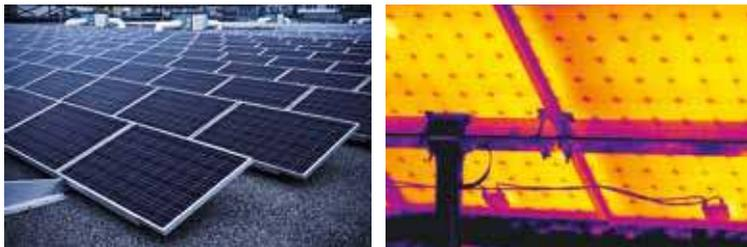
*L'uso delle termocamere per la valutazione dei pannelli solari offre diversi vantaggi. Le anomalie sono facilmente individuabili su un'immagine nitida e - a differenza della maggior parte degli altri metodi - le termocamere possono essere utilizzate per effettuare la scansione di pannelli solari installati durante il loro normale funzionamento.*
