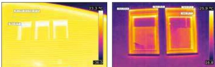
*Il campo dell'immagine tarato automaticamente sulla sinistra è troppo ampio. L'immagine termica tarata manualmente, a destra evidenzia chiaramente la fuga di calore quasi invisibile nell'immagine tarata automaticamente.*
