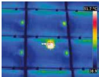
*Questo punto caldo all'interno di una cella solare evidenzia danni fisici all'interno della cella.*
