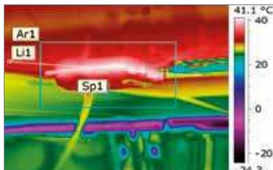
Le termocamere FLIR possono anche essere usate per scansionare gli altri elementi dell'impianto solare, come questo connettore difettoso.
