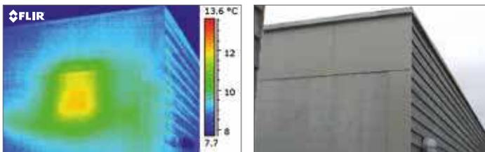
*Questo edificio è più caldo all'interno. Si tratta di una costruzione a strati: calcestruzzo - isolamento - calcestruzzo. Manca una sezione di isolamento che non è possibile scorgere visivamente né dall'interno né dall'esterno. In questo caso la termografia ad infrarossi consente di vedere ciò che sfugge all'occhio umano.*
