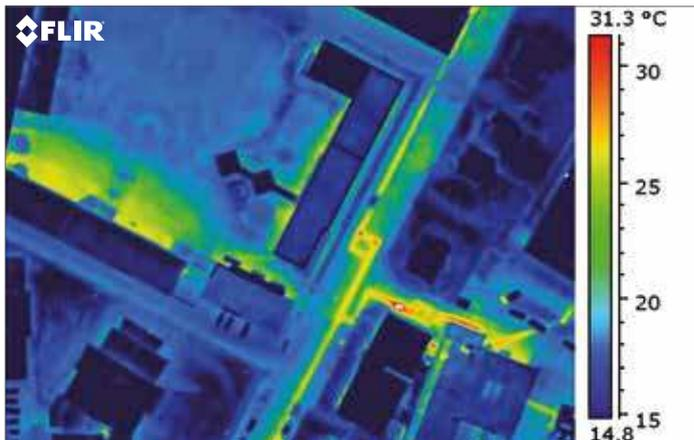
*Un'immagine termica, ripresa dall'alto, evidenzia perdite e difetti di isolamento nel sistema di teleriscaldamento.*
