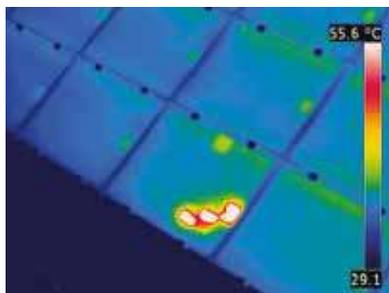
Immagine termica realizzata utilizzando una termocamera FLIR P660 in volo sopra un parco solare. (Termografia concessa da Evi Müllers, IMM)
