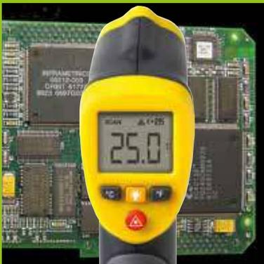
*Termometro IR, che misura la temperatura in un punto.*
