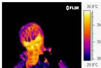
È possibile utilizzare le piccole differenze di temperatura nelle regioni del viso per monitorare le risposte autonome dei soggetti analizzati senza applicare sensori a contatto o impedendo comunque loro i movimenti.
