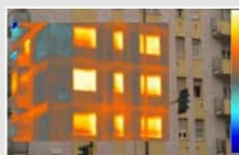
Fig.4: Ponti termici strutturali
