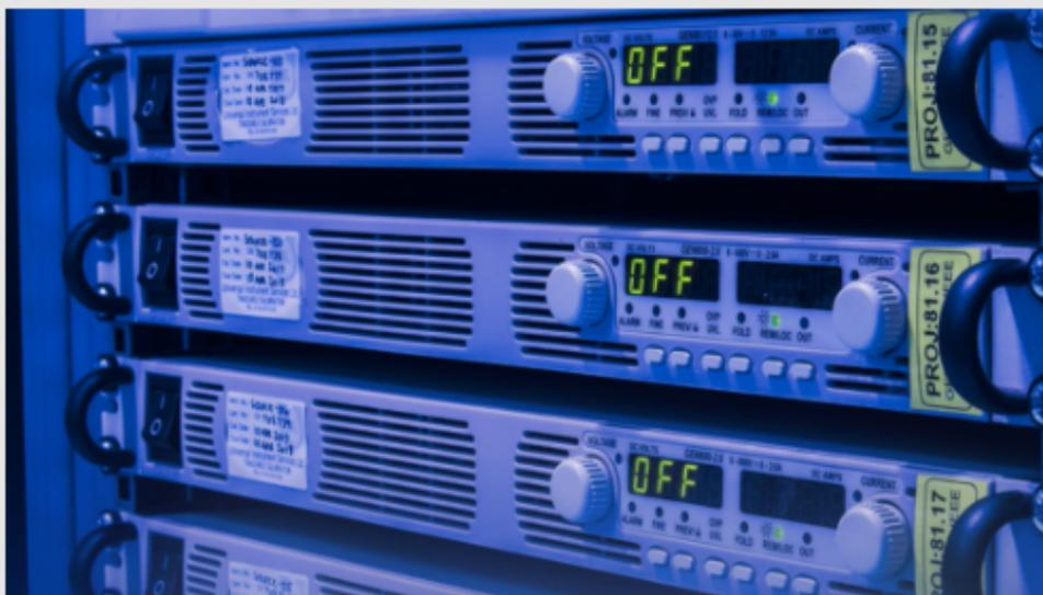
Tutti gli alimentatori programmabili della serie GENESYS+™ funzionano in modalità corrente costante, tensione costante o potenza costante limitata ed inoltre offrono la simulazione della resistenza interna.
