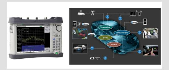
L'automobile è oggi attraversata da una miriade di segnali, su cavo oppure wireless, che gestiscono delle macro-strutture: il sistema telematico; l'infotainment: l'advanced Driver Assistance System (ADAS) che rappresenta il sistema di assistenza alla guida ed è disponibile a vari livelli su quasi tutte le vetture, qualsiasi sia il tipo di propulsione.
